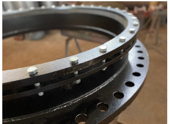
Ação de melhoria realizada na Adutora de Água Tratada DN 1500mm do Sistema Tapacurá | 2021 Instalação de Válvula Borboleta DN 1500mm. com fornecimento de conexões de adaptação.
