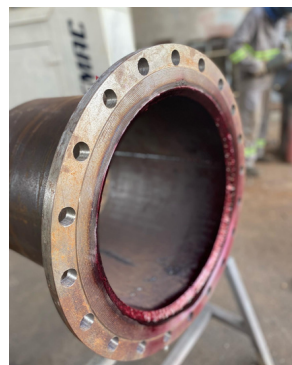
Ensaio Não Destrutivo Líquido Penetrante
